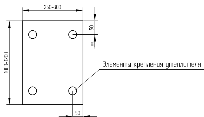
Схема крепления утеплителя на углу здания
