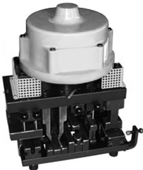
Матрица Р-400 с пневмопрессом
