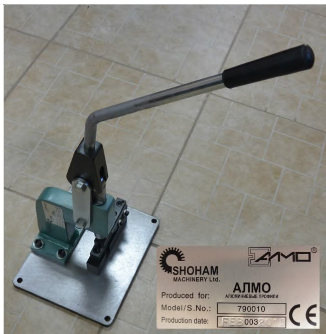
8.1. Ручной пресс 790010 для выполнения отверстия \Phi 10,5 мм в профилях 191010 и 191040 для соединения их угловым сухарем 555150
