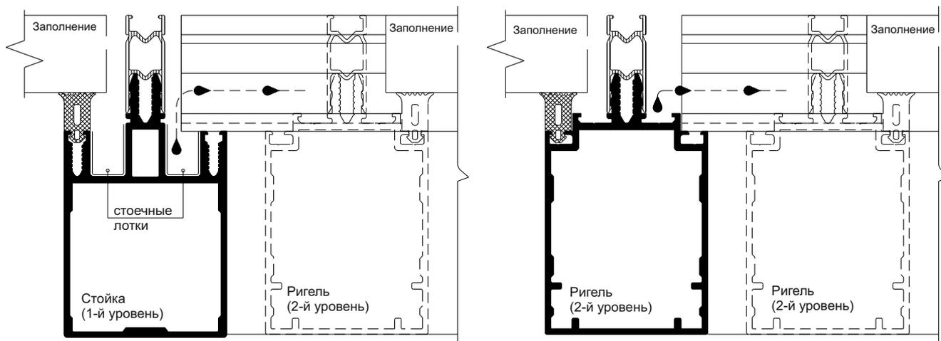
Отвод конденсата из места соединения стойки и ригеля осуществляется из установленного пластикового лотка. Конструкция лотка обеспечивает отвод влаги в пространство между прижимной планкой и декоративной крышкой. Также с помощью лотков происходит выравнивание давления пара и осуществляется циркуляция воздуха.
