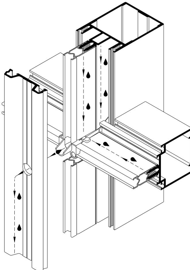
Схема отвода и вентиляции
