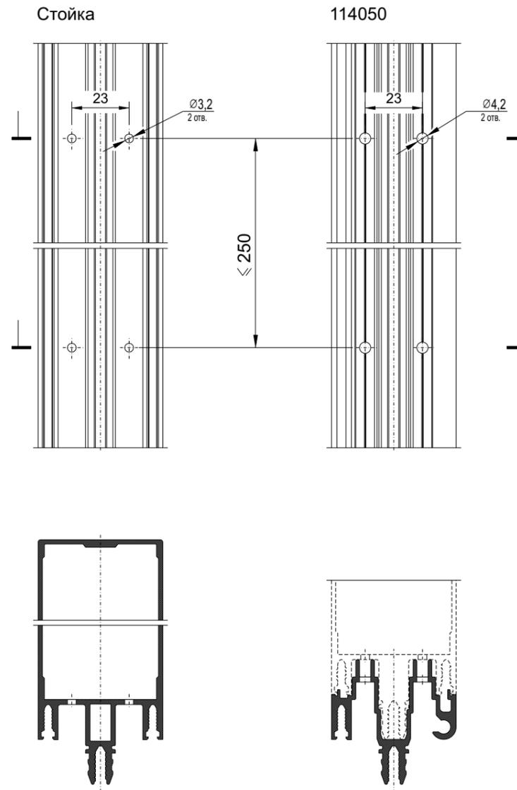
T-соединение ригеля со стойкой и профилем 114050 с использованием кронштейна из профиля 115080
