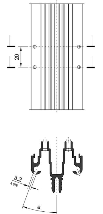
T-соединение ригеля со стойкой с использованием кронштейна из профиля 115080 для повышенных нагрузок от веса заполнения
