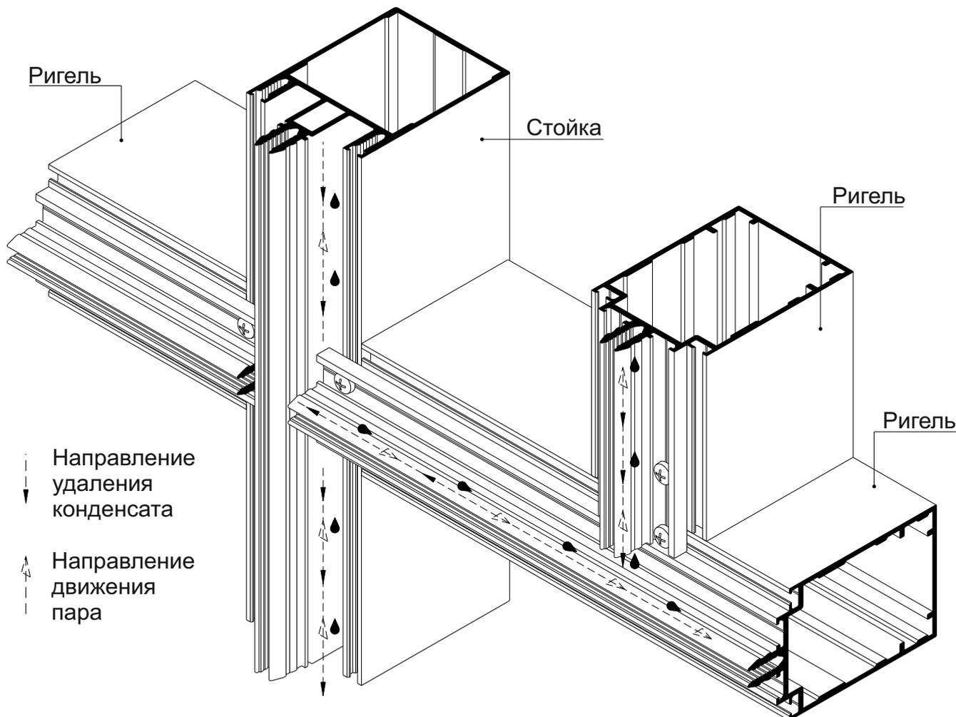
В серии на стойки и ригели устанавливаются одинаковые внутренние уплотнительные профили. Влагоотводящие лотки стойки и ригеля находятся на разных уровнях. Образующийся конденсат по ригельному лотку отводится в стоечный лоток.
