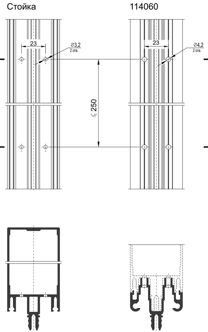
T-соединение ригеля со стойкой и профилем 114060 с использованием кронштейна из профиля 115080
