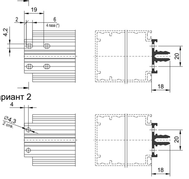
(.) - обработка на пневматическом прессе 710100
