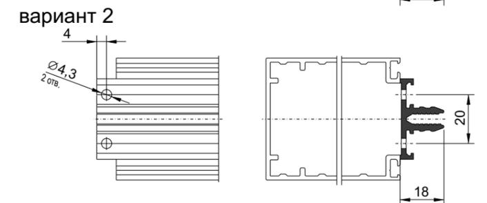
( ) - обработка на пневматическом прессе 710100
