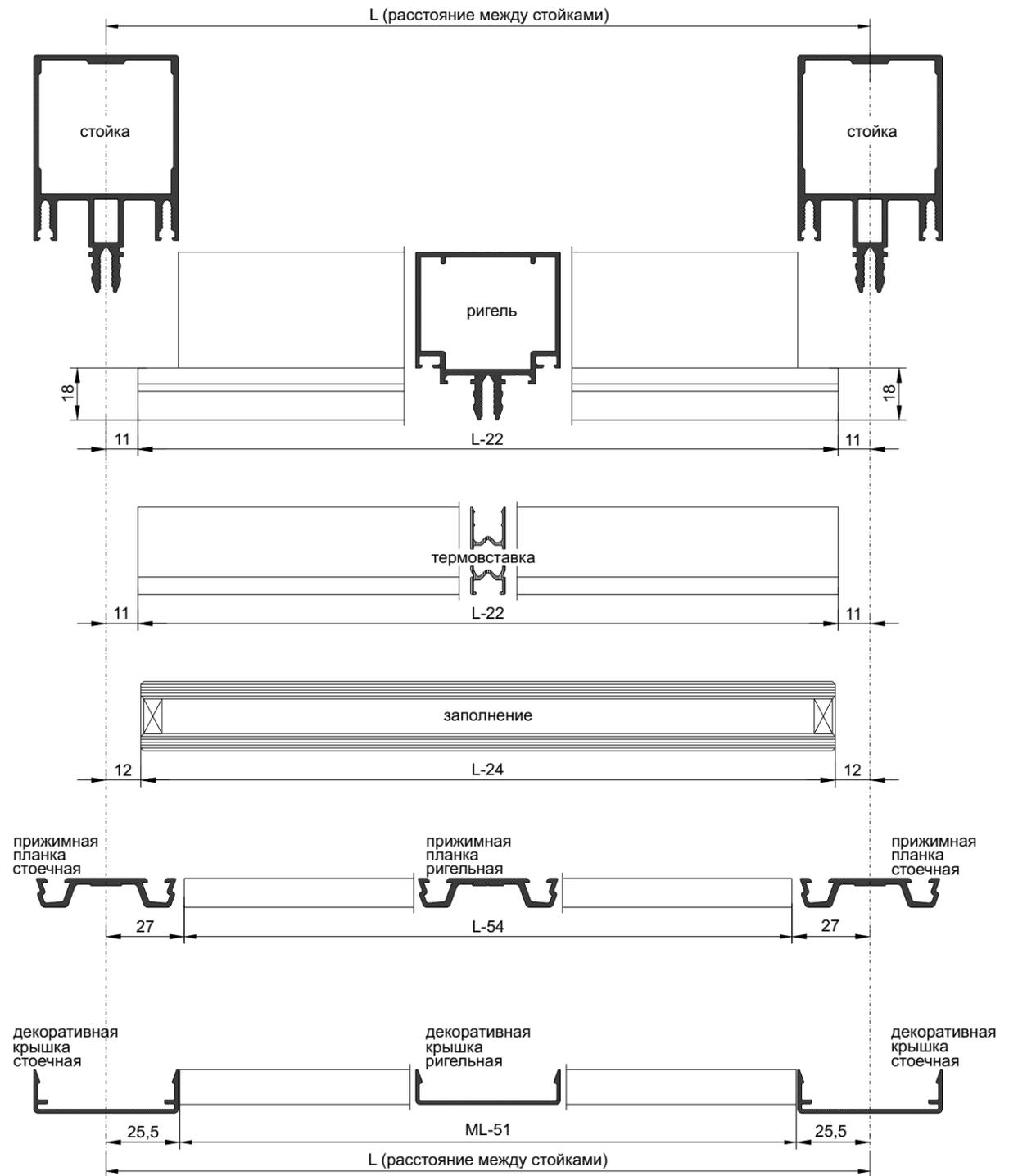
T-соединение ригеля со стойкой с использованием кронштейна из профиля 115080
